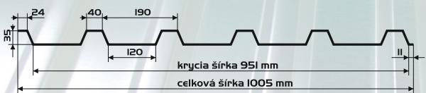
Vyrobený profil je priečne delený na presné dĺžky zadané zákazníkom, takže pri montáži vzniká minimálny, resp. žiadny odpad. Profil je možné vyrobiť v maximálnej dĺžke 10m.
